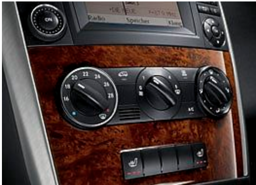
Klimatizácia s prachovým filtrom i prepínačom vnútornej cirkulácie vzduchu.
