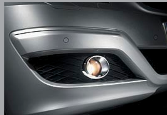
Svetlomet do hmly s pochrómovaným prstencom, nad ním je ultrazvukový snímač systému aktívneho parkovacieho asistenta.
