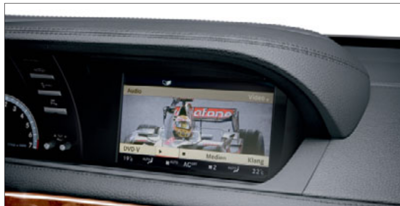
SPLITVIEW ponúka vodičovi a spolujazdcovi na jednej obrazovke súčasne dva rôzne programy.
