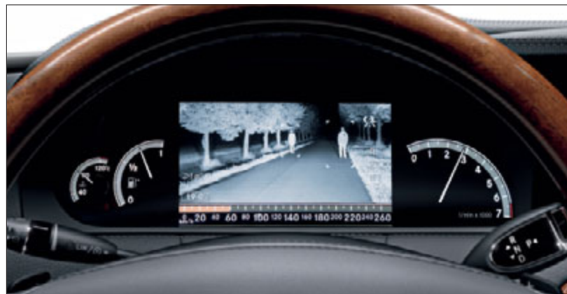
Vďaka infračervenému žiareniu je asistent nočného videnia NIGHTVIEW Plus schopný rozpoznať chodcov až do vzdialenosti 90 metrov.
